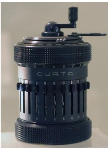
Abbildung 4: Die Curta gilt als die weltweit kleinste mechanische Rechenmaschine. Sie wurde von 1948 bis 1971 in grösseren Stückzahlen in Liechtenstein gefertigt. Quelle: National Museum of Computing, Bletchley Park, England
