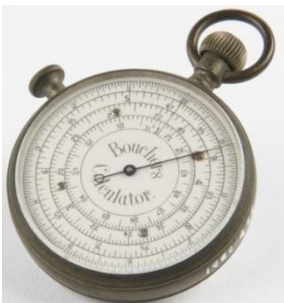
Abbildung 2: Im Vergleich zu Rechenstäben und Rechenscheiben waren Rechenuhren deutlich seltener. Die Skalen dieser analogen Taschenrechner werden durch Drehen der Knöpfe eingestellt. Quelle: Science Museum, London
