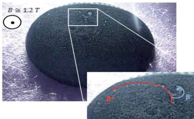
Abb.3. Ablenkung von \beta -Teilchen ( \beta^+ ; \beta^- ) im Magnetfeld
