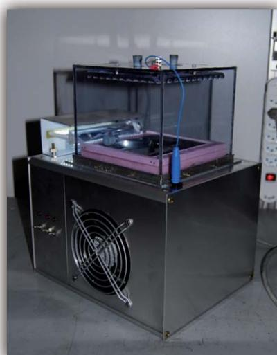
Abb.2. Fertiggestellte Diffusionsnebelkammer mit Peltier-Elementen
